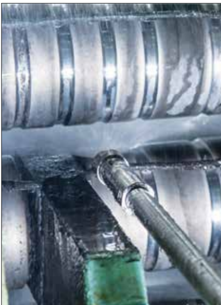
شکل ۴ - استفاده عملیاتی از نازل‌های جدید شرکت پریمتالز در کارخانه فولاد هیوندای کره
