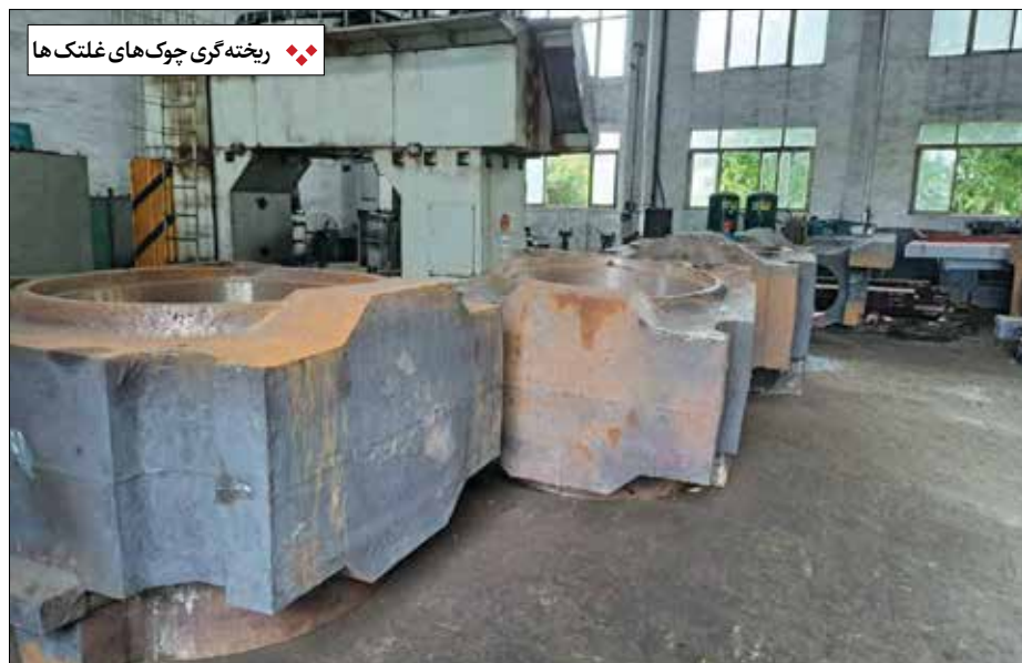
♦♦ فورجینگ غلتک‌های پشتیبان قفسه‌های فینیشینگ و رافینگ
