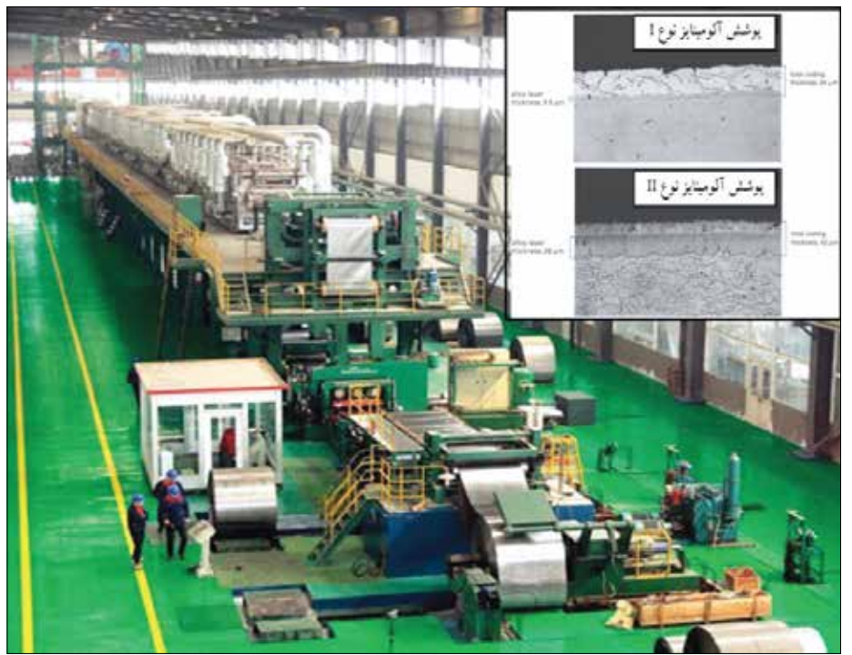
شکل ۱- خط آلومینایز کردن ورق فولادی و انواع ورق‌های فولادی آلومینایز شده.
